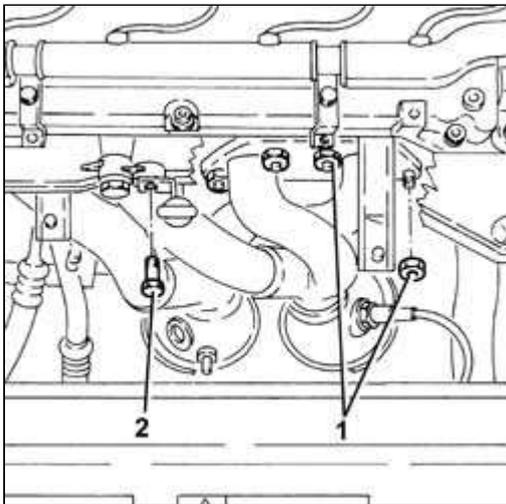
1. Befestigungsmuttern des Katalysators am Zylinderkopf abschrauben.
