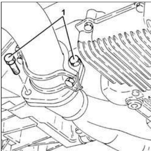
1. Befestigungsschrauben des Katalysators am vorderen Abschnitt der Abgasleitung herauschrauben.
