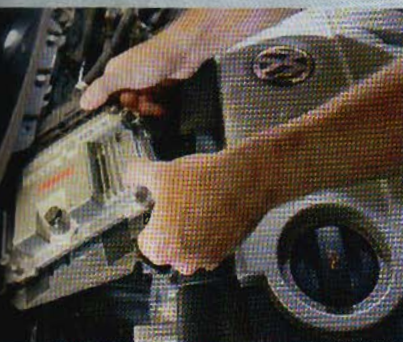
Buschgeschäft: Einbau eines modifizierten Steuergeräts. Freischaltung erforderlich
